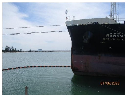
ภาพที่ 2-2 การติดตั้งอุปกรณ์ป้องกันการรั่วไหลน้ำมัน ขณะมีกิจกรรมการขนถ่าย
